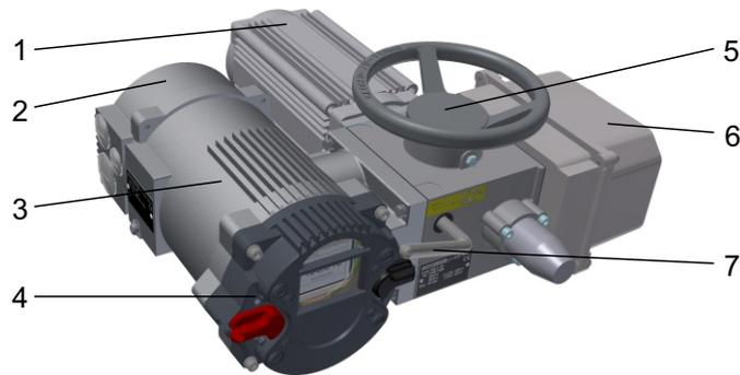
**Bild 1:** 1...Motor, 2...Anschlussraum, 3...SMARTCON Steuerung, 4...Bedienelement, 5...Handrad, 6...Meldedeckel, 7...Handhebel
